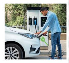
In vehículo eléctrico funciona de manera similar a un teléfono celular, es decir, cuenta con una batería que se conecta a una toma de corriente para recargarse. Por la capacidad energética que se requiere para alimentar al motor, esta carga requiere de varias horas en una toma de corriente doméstica de 220 voltios, dependiendo también de la capacidad del cargador proporcionado ( los de 3 kW v 7 kW son los más comunes).
