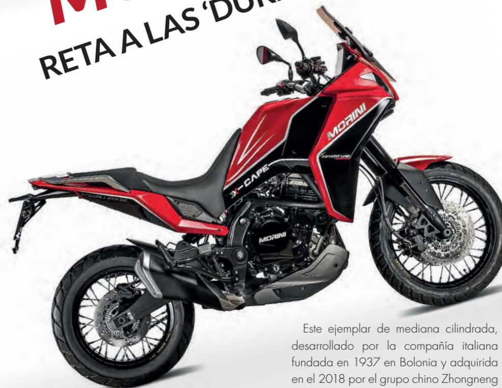
Este propulsor le permite alcanzar una velocidad máxima de 175 km/h y el tanque de gasolina de 18 litros le proporciona una autonomía de 300 kilómetros.
